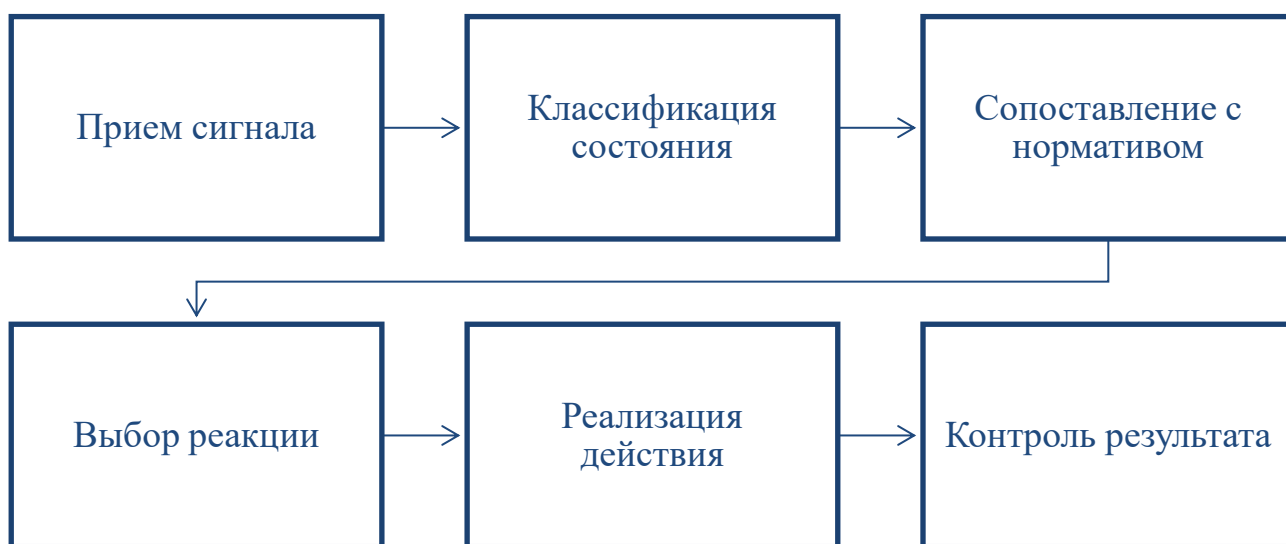
Рисунок 1 - Функциональная структура принятия решений оператором в автоматизированной системе управления (источник: разработано авторами)
